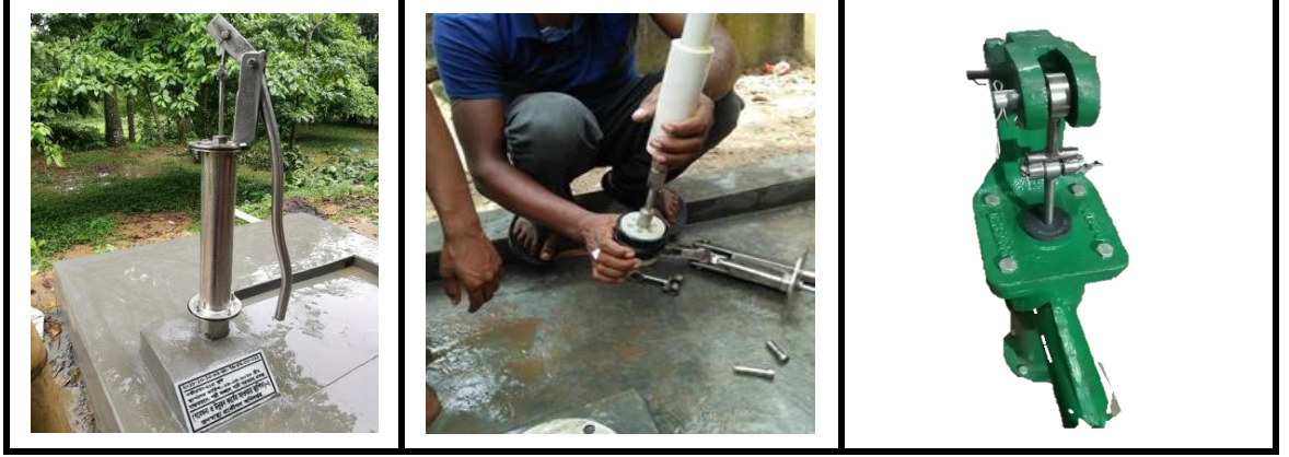
চিত্রঃ পরীক্ষামূলক পরিবর্তিত নকশার তারা পাম্পযুক্ত নলকূপ
