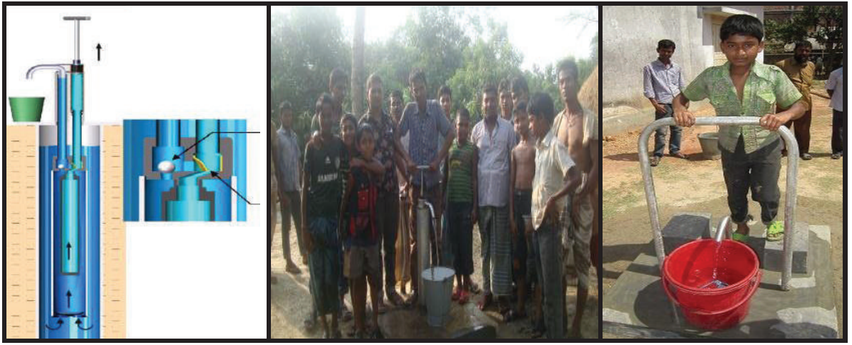
চিত্রঃ হস্ত চালিত ও পা চালিত হাইব্রিড ও হাইড্রোলিক পাম্প
