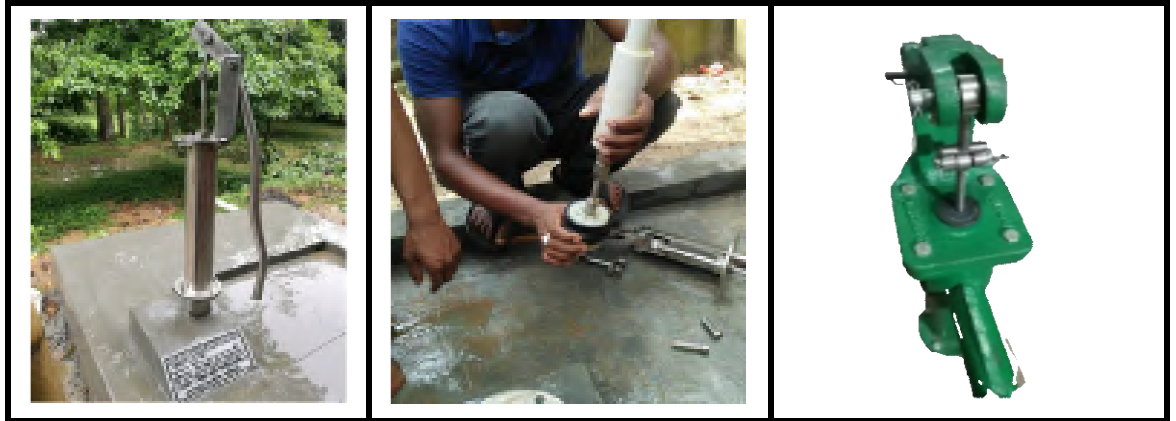
চিত্রঃ পরীক্ষামূলক পরিবর্তিত নকশার তারা পাম্পযুক্ত নলকূপ
